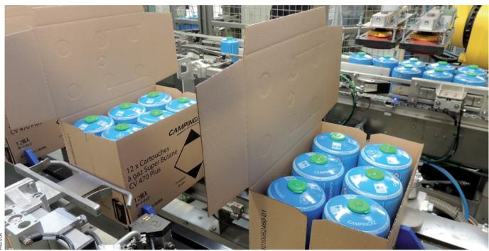
Installée en septembre 2021 dans l'usine de Saint-Genis-Laval (Rhône), l'encaisseuse wrap Jyga peut gérer jusqu'à sept formats de caisses en carton.
